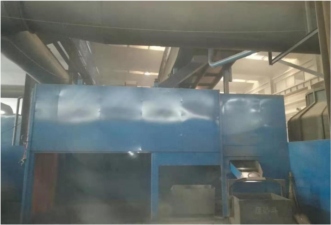
清砂工序封闭集气罩
